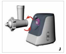
dann haben Sie vermutlich die Schnecke nicht weit genug eingesteckt. Fassen Sie die Achse der Schnecke und rütteln und drehen Sie die Schnecke etwas, bis sie sich nach innen schieben lässt. Wenden Sie keine Gewalt an! Wenn alles korrekt zusammengesetzt ist, schließt die flache Seite des Kunststofffingers bündig mit dem Schneckengehäuse ab.
