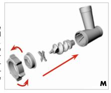
Nehmen Sie jetzt die Schneckenführung. Die flache Seite mit der Aussparung sollte beim Aufsetzen zur Schnecke zeigen. Drehen Sie die Schneckenführung dabei, bis die Aussparung in der Scheibe über den Führungszapfen im Schneckengehäuse gleitet.
