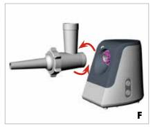
**ACHTUNG:** Verwenden Sie keine Werkzeuge, um den Verschlussring festzuziehen und achten Sie darauf, den Verschlussring nicht zu verkanten. Andernfalls könnte das Gewinde beschädigt werden. Wenn sich der Verschlussring nur schwer aufschrauben lässt, dann fetten Sie das Gewinde mit etwas Speiseöl.
